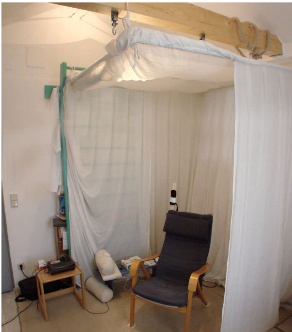
Abb.: Lage des Probandensessels im verwendeten „Swiss-Shield-Baldachin“, der uns freundlicherweise leihweise kostenfrei von ESAG-Österreich zur Verfügung gestellt worden war. Daneben (im Bild links) erkennt man einen Teil des GDV-Mess-Systems, mit dem mögliche Stessreaktionen der Versuchsperson überprüft worden waren.
