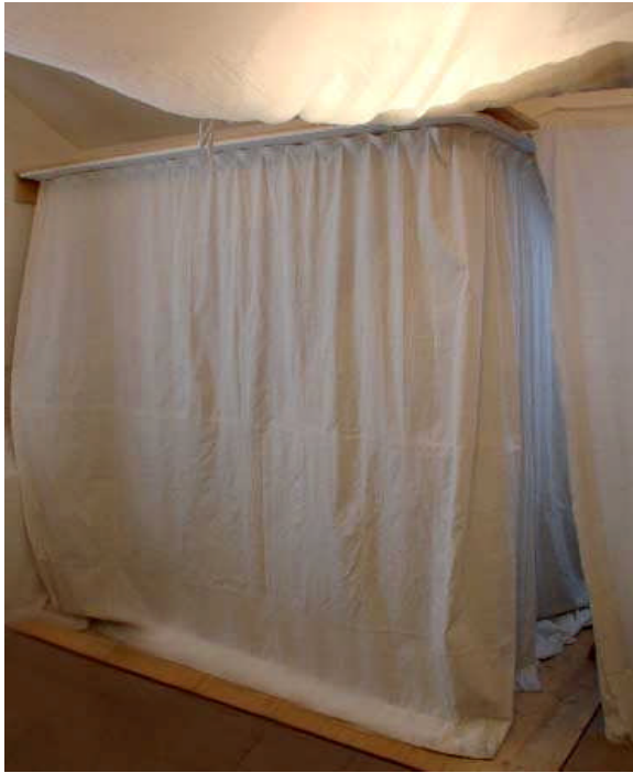
Abb.: Waren der Placebovorhang und möglicherweise dahinter auch ein oder zwei Abschirmvorhänge geschlossen, sah die Versuchsperson trotzdem immer die hier ausschnittsweise dargestellte Situation: Es konnte dadurch für ProbandInnen nicht wissentlich erkannt werden, welche Expositionsanlage gerade vorhanden war.
