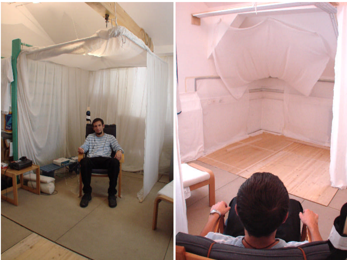
Abb. links: Versuchsperson (gestelltes Foto) auf dem Untersuchungs-Sessel sitzend, links im Bild unweit des Kopfes an der Lehne des Messsessels montiert, ist das Maschek-Mobilfunk-Dosimeter zu erkennen, daneben das Erfassungsgerät für Hautwiderstand, Puls usw., noch weiter links die Messeinheit des GDV-Systems. Ansicht vom „HF-Einstrahlungs-Messtor“ aus gesehen. Abb. rechts: Ansicht aus der Sicht hinter dem Probanden in Richtung des „Tores“, hier wiederum mit geöffnetem Wand-Abschirmvorhang gezeigt.
