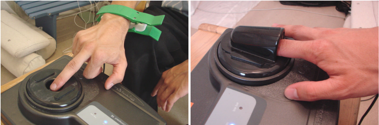
Abb. links: Richtige Positionierung des zu messenden Fingerkuppenareals auf der Glasplatte der GDV-Camera (zur besseren Anschaulichkeit ohne Abdeckung gezeigt). Abb. rechts: Wie links, jedoch mit angebrachter Lichtschutz-Abdeckung.
